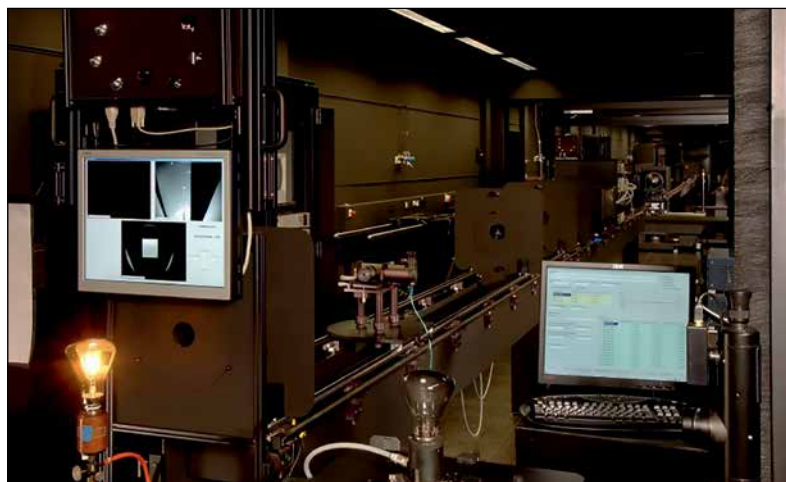
Bild 14: Die 40 m lange photometrische Bank zur Realisierung und Weitergabe der Einheiten der gerichteten Photometrie
