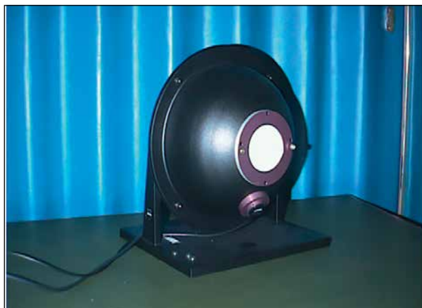
Bild 16: Glühlampenbasierte Normale zum Transfer der Leuchtdichte-Einheit
