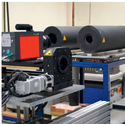
Strahlungsmessplatz der PTB zur Kalibrierung von Temperaturstrahlern und Wärmebildkameras
