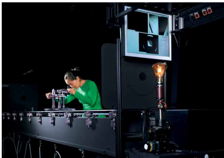
Bild 1: Kameragestützte mechanische Ausrichtung einer Lichtstärke-Normallampe an der Photometerbank. Quelle: PTB.
