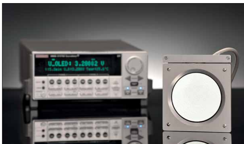
Bild 7: Temperaturgeregeltes OLED-Transferrnormal auf Basis kommerziell erhältlicher OLEDs
