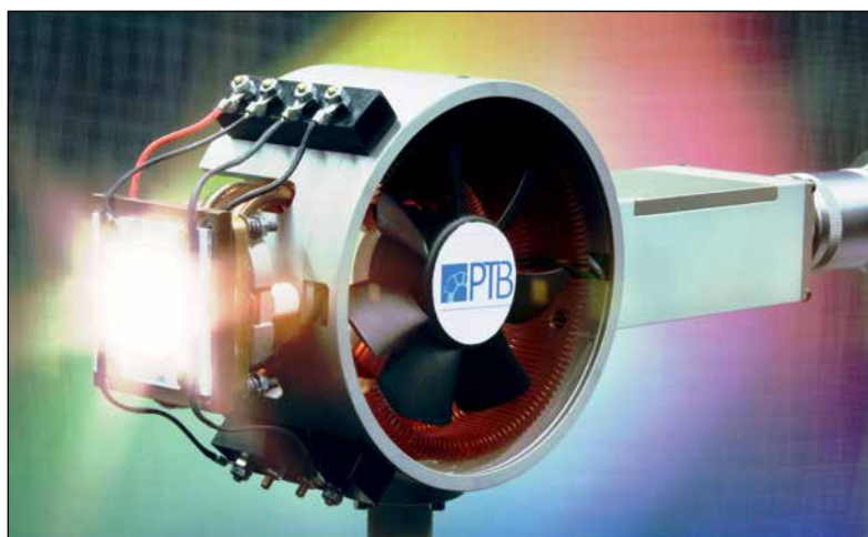
Bild 6: Temperaturgeregeltes LED-Transferrnormal auf Basis von Höchstleistungs-LEDs mit Lichtströmen von bis zu 2500 Lumen
